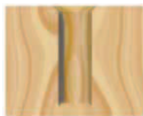
Esempio di foro cieco con svasatura
