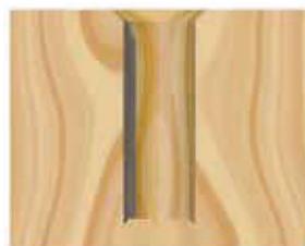
Esempio di foro cieco con svasatura
