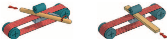
Guides for sanding round (1) or square elements (2) - Guías para lijar piezas redondas (1) o cuadradas (2)
